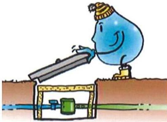
**Le compteur** : les périodes de grand froid sont les premières causes de casse ou de fuite sur le compteur. Si votre regard n'est pas isolé, nous vous conseillons de calfeutrer le compteur en le recouvrant d'un matériau isolant comme la mousse de polyéthylène ou une plaque de polystyrène.
